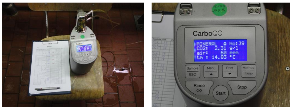
MĚŘENÍ KONCENTRACE VOLNÉHO CO 2 PŘÍSTROJEM CARBO QC, MĚŘICÍ SESTAVA A DETAIL DISPLEJE.
